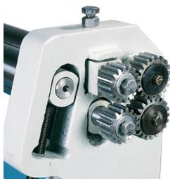
Der Antrieb der Biegewalzen erfolgt über ein massives Zahnradgetriebe.
