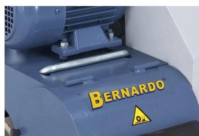
Ausziehbarer Tragegriff um den Transport der Maschine zu erleichtern.
