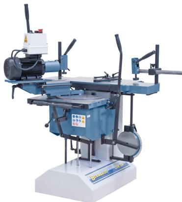
Das Topmodell aus der LBM-Reihe ist mit einem drehbaren Bohraggregat nach links und rechts bis 60° ausgestattet und ist dadurch die ideale Lösung für den Treppen-, Fenster- und Fassadenbau. Dadurch das der Motor mittels Einhandbedienung bewegt wird und der Arbeitstisch fix montiert ist, können auch große Werkstücke wie z.B.: Türen leicht bearbeitet werden.
