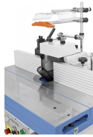
Die Frässpindel ist von -10^\circ bis +45^\circ schwenkbar und 180 mm höhenverstellbar.
