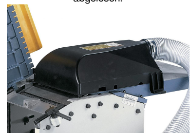
Kombinierte Späneauswurphaube verwendbar zum Abrichten und Dickenhobeln.
