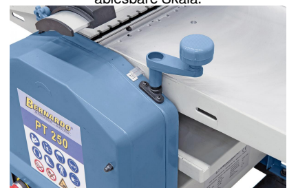
4-fach geführter Dickenanschlag, die Höheneinstellung erfolgt über eine leicht ablesbare Skala.
