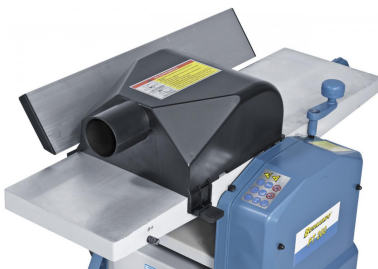
Kombinierte Absaughaube, wahlweise verwendbar zum Abrichten bzw. Dickenhobeln.
