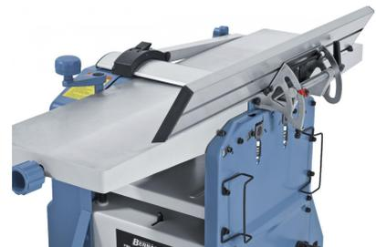
Aluminium-Abrichtanschlag, verwendbar von 90° bis 45°.
