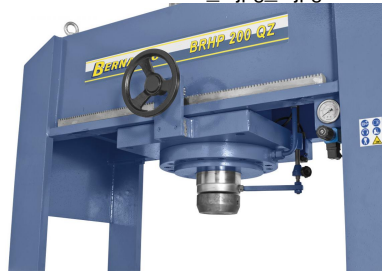
Mittels Handrad kann der Kolben nach links oder rechts verschoben werden.
