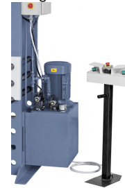
Erhöhte Sicherheit durch Zweihandbedienung und Not-Aus-Schalter im Bedienpult.
