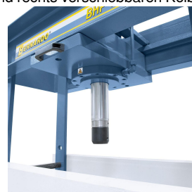
Großdimensionierter Kolben für höchste Beanspruchung.
