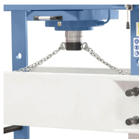
Inklusive Vorrichtung zur Höhenverstellung des Arbeitstisches.
