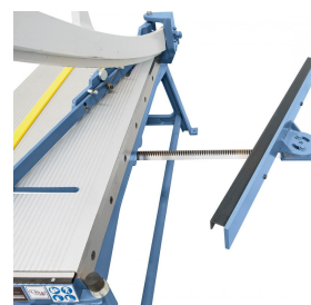
Verstellbarer Hinteranschlag für erweiterten Einsatzbereich.
