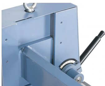
Großdimensionierte Führung garantiert ein exaktes Biegen.
