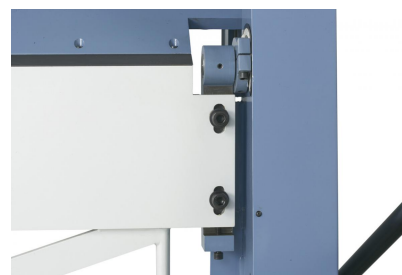
Gewünschte Blechstärke einfach einstellbar über Biegewange.
