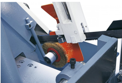
Kugelgelagerte Sägebandführung und Spänebürste für optimale Schnittergebnisse.
