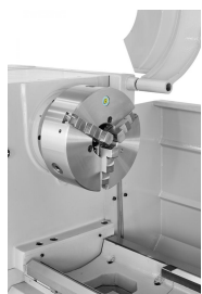
Vorteil des Bernardo-Stahlfutters: PO3-315 mm / D8: Monoblock,- Grund,- Umkehr- und Aufsatzbacken lieferbar.
