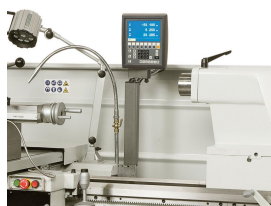
Die serienmäßige 3-Achs-Positionsanzeige garantiert einfacheres Arbeiten und höhere Genauigkeit.
