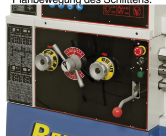
Vorschubgetriebe leicht und präzise schaltbar, geschliffene Zahnräder sorgen für einen ruhigen Lauf.
