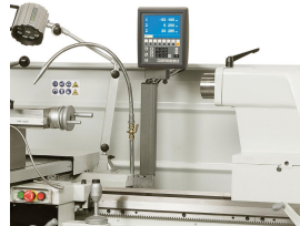
Die serienmäßige 3-Achs-Positionsanzeige garantiert einfacheres Arbeiten und höhere Genauigkeit.
