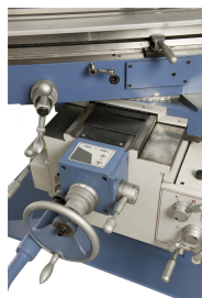
Großdimensionierte Flachführungen garantieren Stabilität bei hoher Fräsbelastung, Frästisch schwenkbar von -45^\circ bis +45^\circ .
