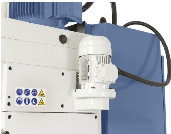
Vorschubmotor zur Reduzierung der Positionierzeiten der Pinole
