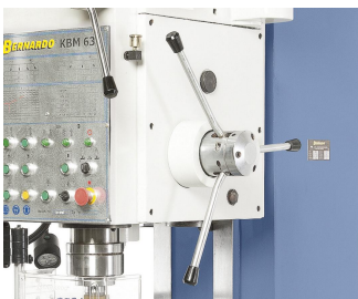
Sterngriff für manuelle Pinolenzustellung, Kupplungshebel für automatischen Vorschub. Übersichtlich aufgebauter Bohrkopf mit sämtlichen Schalt- und Bedienelementen.
