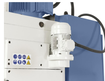
Vorschubmotor zur Reduzierung der Positionierzeiten der Pinole
