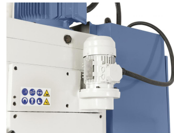
Vorschubmotor zur Reduzierung der Positionierzeiten der Pinole
