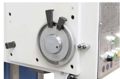
Gewindeschneideinrichtung mit Drehrichtungsumkehr, ideal für die Serienfertigung
