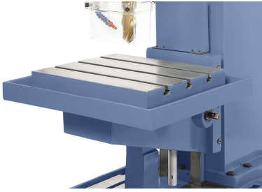
Massiver großer Arbeitstisch, präzise oberflächenbearbeitet.
