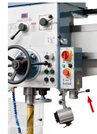
Drehrichtungsänderung bzw. Ein- und Auskuppeln der Spindel erfolgt mittels Pilotschalter an der Unterseite des Bohrkopfes
