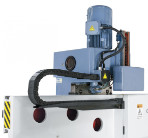
Gegengewicht für die Pinole und Energieführungskette an der Rückseite des Bohrkopfes.
