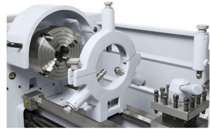
Feststehende Lünette zum Abstützen von langen und dünnen Werkstücken.
