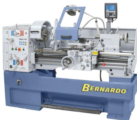
Die Universaldrehmaschine Smart 410 eignet sich zur Ausführung von leichten und mittelschweren Dreharbeiten. Schon die Grundausstattung beinhaltet alle wichtigen Zubehöre (3-Backenfutter, Lünetten, Wechselräder, ...), wodurch diese Maschine universell einsetzbar ist. Zur Reduzierung der Fertigungszeiten ist dieses Modell serienmäßig mit einer 3-Achs-Digitalanzeige ausgestattet.
