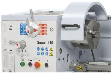
Der robuste Spindelstock und die dynamisch ausgewuchtete Hauptspindel ermöglichen auch bei hohen Drehzahlen höchste Genauigkeit und Laufruhe.
