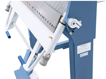
Die großdimensionierte Führung der Biegewange sorgt für ein präzises Arbeiten.
