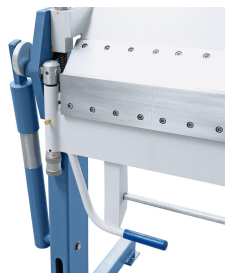
Ein Hilfszylinder unterstützt den Biegevorgang beim Abkanten.
