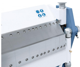
Segmentierte Ober- und Biegewange für eine große Anzahl von Biegemöglichkeiten.
