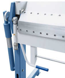
Ein Hilfszylinder unterstützt den Biegevorgang beim Abkanten.
