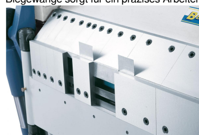
Durch die segmentierte Biegewange können auch entgegengesetzte Biegungen durchgeführt werden.
