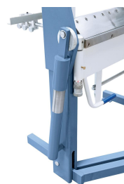
Ein Hilfszylinder unterstützt den Biegevorgang beim Abkanten.
