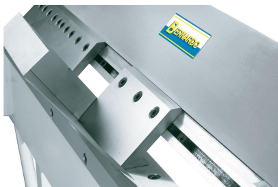
Durch die einzeln herausnehmbaren Segmente können auch Schachteln, Boxen usw. gebogen werden.
