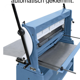
Hinteranschlag für Serienarbeiten im Lieferumfang enthalten.
