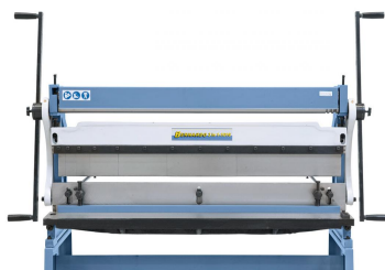
Durch die herausnehmbaren Klavier-einsätze ergeben sich eine hohe Anzahl von Biegemöglichkeiten.
