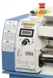
Alle Bedienelemente sowie sämtliche Tabellen übersichtlich am Spindelkopf angebracht.
