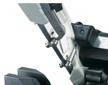
Kugelgelagerte Sägebandführung mit Schnellverstellung zum Anpassen an die Werkstückbreite garantiert ein optimales Arbeitsergebnis.
