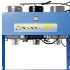
Seitlich verschiebbarer Kolben für universellen Einsatz.
