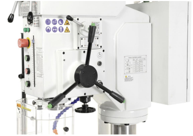
Serienmäßig mit 3-fachem automatischem Bohrvorschub ausgestattet
