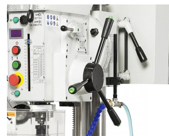
Der Bohrvorschub erfolgt wahlweise per Hand oder mittels Elektromagnetkupplung (0,1 / 0,2 / 0,3 mm/U)
