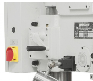
Einfache Höhenverstellung des Bohrkopfes mittels Kurbel.
