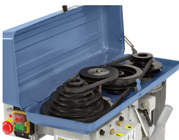
Hohe Laufruhe durch gewuchtete Antriebsscheiben.
