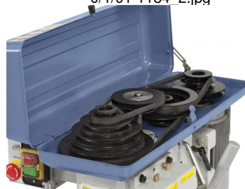
Hohe Laufruhe durch gewuchtete Antriebsscheiben.
