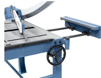
Verstellbarer Hinteranschlag (0 - 585 mm), einstellbar mittels Handrad an der Vorderseite.
