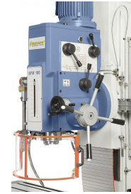
Die Pinolenzustellung erfolgt wahlweise per Hand oder mittels automatischem Pinolenvorschub (0,1 / 0,15 / 0,3 mm/U).
