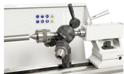
Zum wirtschaftlichen Arbeiten kann die Maschine mit einem Revolverkopf ausgestattet werden
