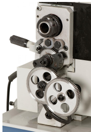
Serienmäßig ausgestattet mit Wechselrädern in Metallausführung zum Gewindeschneiden.
