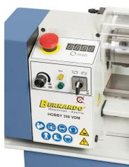
Elektronische, stufenlose Drehzahlregelung,
