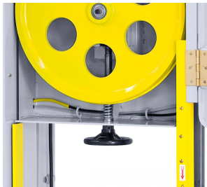
Die Einstellung der Blattspannung erfolgt mittels Handrad.
