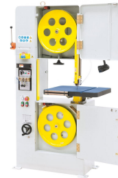
Kugelgelagerte Sägebandführung, einstellbar auf die jeweilige Werkstückhöhe.
