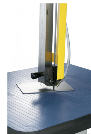
Kugelgelagerte Sägebandführung, einstellbar auf die jeweilige Werkstückhöhe.
