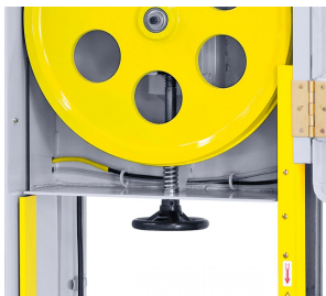
Die Einstellung der Blattspannung erfolgt mittels Handrad.
