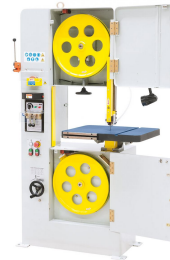
Kugelgelagerte Sägebandführung, einstellbar auf die jeweilige Werkstückhöhe.
