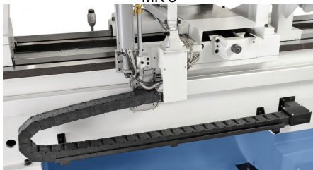
Inklusive Kabelführung über Energiekette
