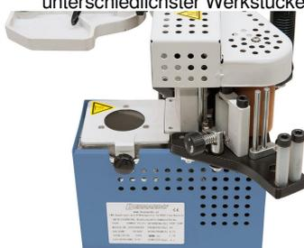
Hohe Sicherheit durch verschließbares Leimbecken – beim Kippen des Gerätes besteht keine Verbrennungsgefahr
