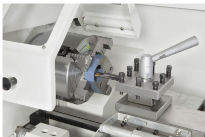
Planscheibe 125 mm (Option), ideal zum Aufspannen von asymmetrischen Werkstücken.
