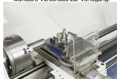
Zur Reduzierung der Nebenzeiten kann die Maschine mit einem Schnellwechselstahlhalter Bernardo Größe 20 ausgestattet werden.
