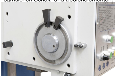
Gewindeschneideinrichtung mit Drehrichtungsumkehr, ideal für die
