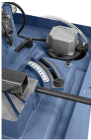
Schwenkbarer Sägebügel für Gehrungsschnitte bis 60°
