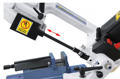
Sägebandführung kann auf die Materialbreite eingestellt werden
