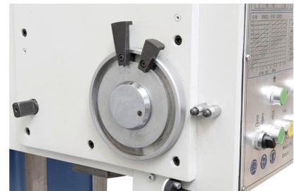
Gewindeschneideinrichtung mit Drehrichtungsumkehr, ideal für die Serienfertigung
