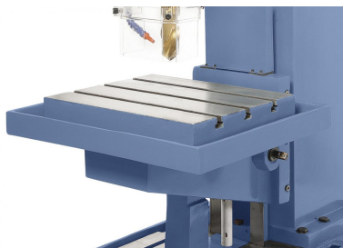
Massiver großer Arbeitstisch, präzise oberflächenbearbeitet.
