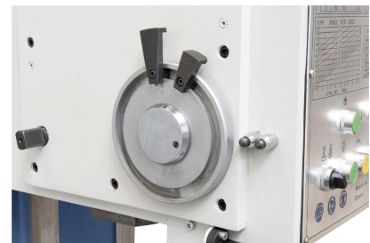
Gewindeschneideinrichtung mit Drehrichtungsumkehr, ideal für die Serienfertigung
