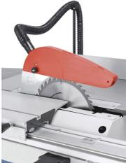
Der Sägeblattschutz mit integriertem Absaugstutzen ist am Spaltkeil befestigt.
