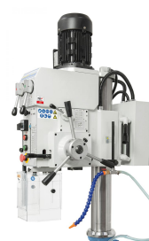
Serienmäßig mit 3 automatischen Bohrvorschüben ausgestattet.
