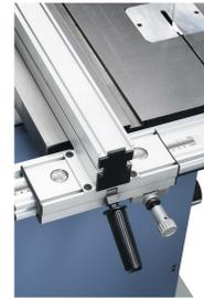
Der Längsanschlag ermöglicht durch die integrierte Lupe ein exaktes Ablesen der eingestellten Schnittbreite, zusätzlich mit Feineinstellung.
