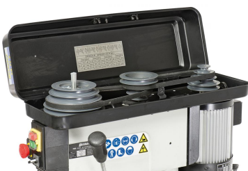
Gewuchtete Grauguss-Antriebsscheiben für hohe Laufruhe, die hochwertigen Keilriemen sorgen für eine optimale Kraftübertragung
