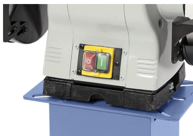
EIN-AUS Schalter nach IP 54 mit Unterspannungsauslöser.
